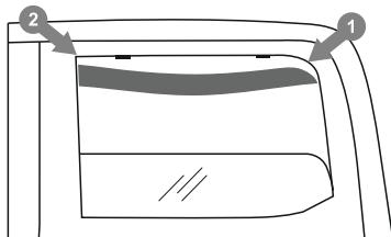
7. El deflecto se debe instalar comenzando por la parte posterior. Para ello, coloque la parte posterior del marco del deflecto en el riel y mueva la parte frontal hacia arriba. Coloque totalmente el marco del deflecto entre los soportes de sujeción y el filo de goma, tal y como se muestra en la imagen.
