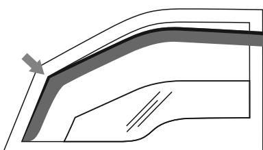
4. Déplacez le déflecteur vers l'avant, en ajustant complètement le cadre du déflecteur dans le canal. Assurez-vous que le déflecteur est placé au-dessus du cadre inférieur de la fenêtre.
