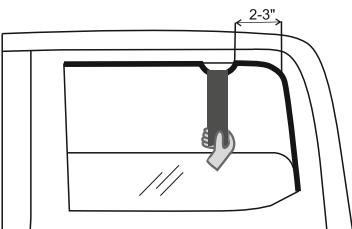
2. Para colocar el accesorio, doble el filo de goma desde el marco posterior de la ventana 2-3 pulgadas, utilizando una lámina metálica especial, tal y como se muestra en la imagen.
