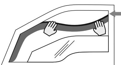
5. En pliant la partie centrale du déflecteur vers l'extérieur, insérez la partie arrière du déflecteur dans le canal en laissant un espace au-dessus de celui-ci.
