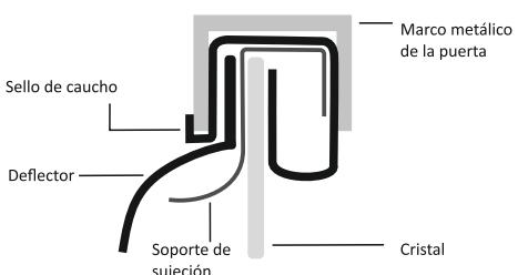
4. La imagen muestra cómo colocar el soporte de sujeción.
